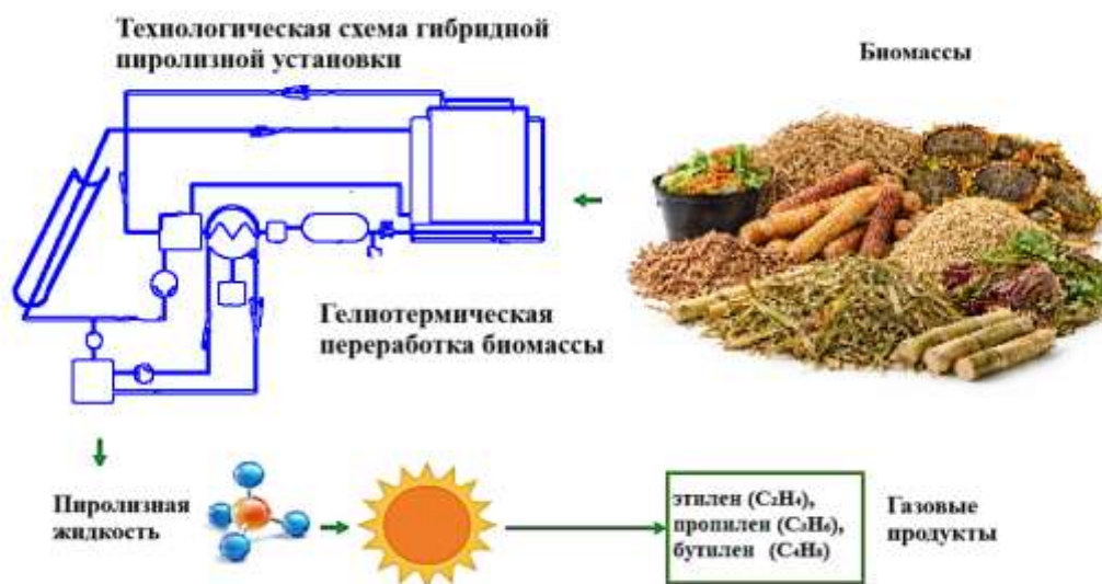
Рис. 1. Блок-схема получения альтернативных топлив на основе гелиотермической переработки биомассы.
