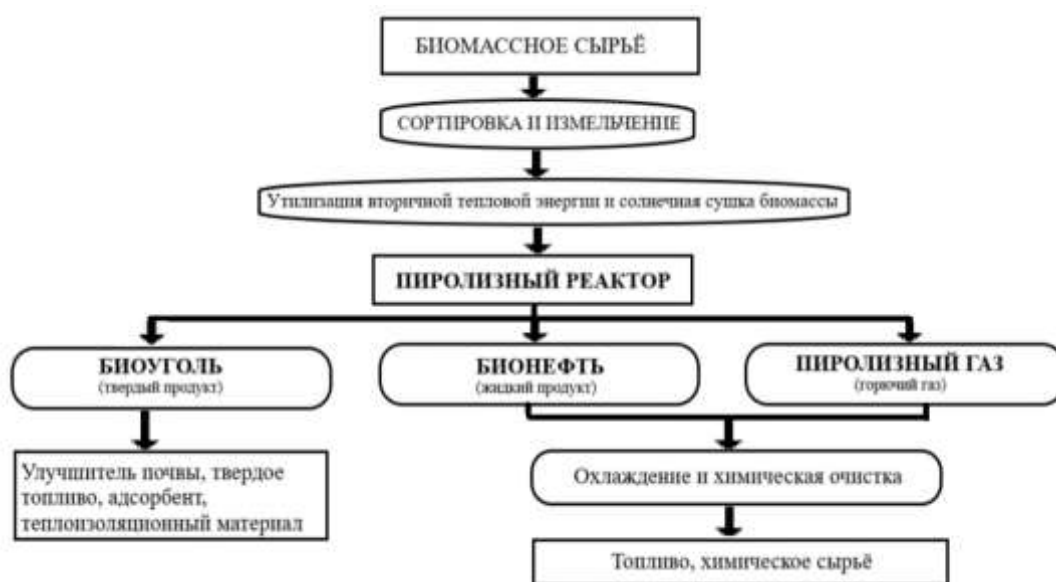
Рисунок 1. Технологическая схема переработки биомассы методом пиролиза и использования продуктов пиролиза.
