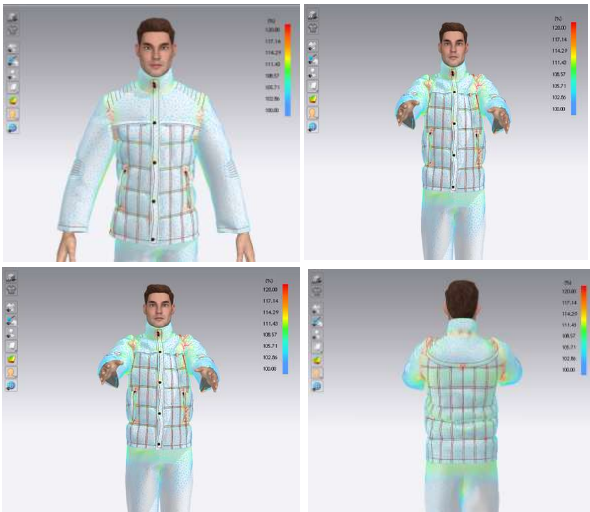
1-rasm.Clo D3 dasturida erkaklar kurtkasida mexanik ta'sirlari ko'proq uchraydigon qisimlar.
